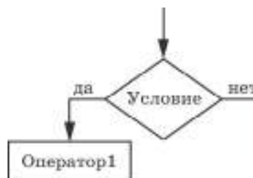
Рис. 55. Блок-схема неполного условного оператора
