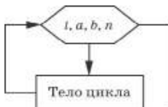
Рис. 115. Блок-схема цикла с параметром
